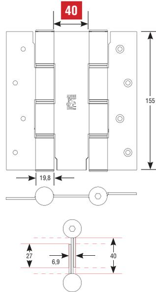
Per porte da 37 ÷ 50 mm - For doors from 37 to 50 mm - Для дверей от 37 до 50 мм
