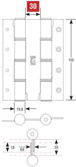
Per porte da 27 ÷ 40 mm - For doors from 27 to 40 mm - Для дверей от 27 до 40 мм
